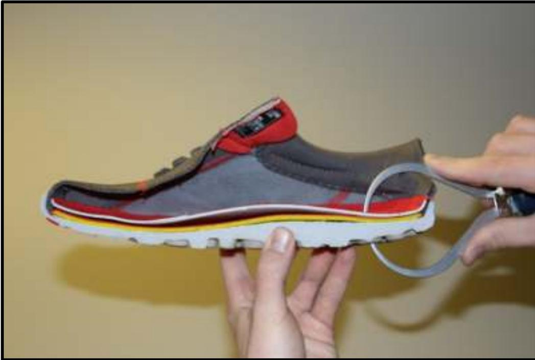
**Fig B-2.** La jauge d'épaisseur doit être positionnée au milieu du talon d'un point de vue latéral.
