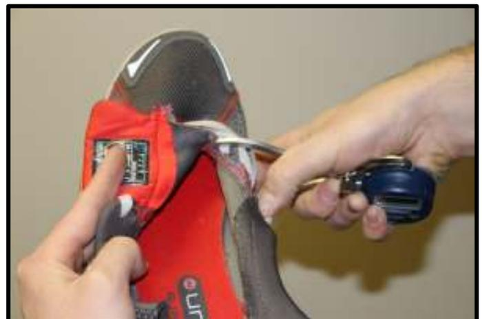
**Fig C-2.** La jauge doit être placée au milieu de la chaussure d'un point de vue supérieur.
